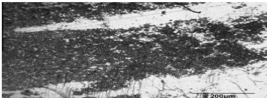
Figura 12: Morfologia da superfície de placa de aço inoxidável 316L mostrando ruptura do acabamento superficial
