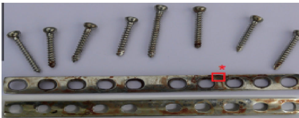
Figura 11: Placa e parafusos de aço inoxidável 316L recuperados
